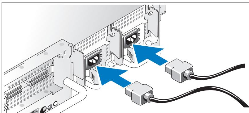
Подключите монитор (необязательно) и блок питания системы, после чего подключите шнур питания к системе. Если система включает плату расширения с разъемом видеовыхода, *не подключайте* монитор к встроенному видеоразъему. Кабель монитора следует подключить к разъему на плате расширения.
