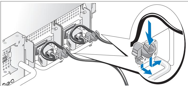
Прикрепите кронштейн фиксации на правом изгибе рукоятки разъема шнура питания. Согните системный шнур питания в петлю (см. рисунок) и прикрепите его к кабельному зажиму кронштейна. Повторите данную процедуру со вторым источником питания.
