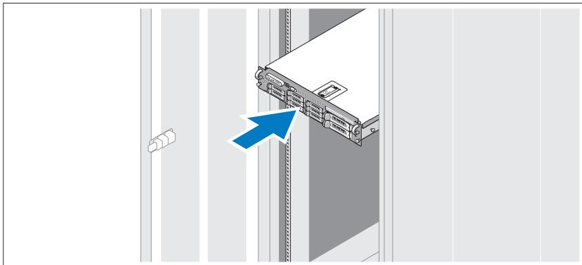
Después de leer las instrucciones de seguridad incluidas en la documentación del sistema relativa a la instalación del rack, instale los rieles y el sistema en el rack.
