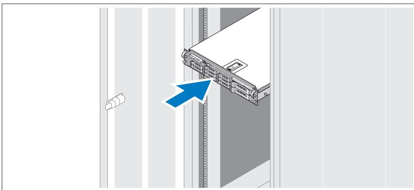
Po przeczytaniu „Instrukcji dotyczących bezpieczeństwa”, przedstawionych w dokumentacji instalacyjnej stelaża przeznaczonego dla systemu, zainstaluj na stelażu prowadnice oraz zestaw.
