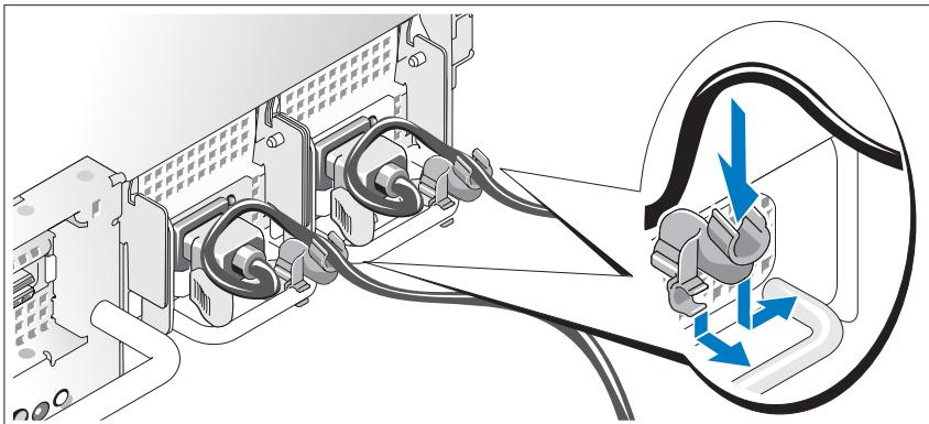
Připevněte retenční svorku napájecího kabelu do pravého ohybu rukojeti napájecího zdroje. Napájecí kabel ohněte do tvaru oka, jak je znázorněno na obrázku, a připevněte ho do příslušného úchytu. Celý postup zopakujte u druhého napájecího kabelu.
