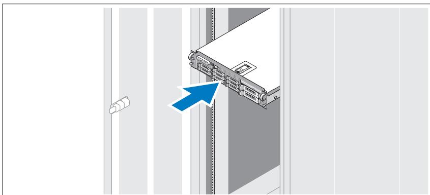
Μόλις ολοκληρώσετε την ανάγνωση των “Οδηγιών ασφαλείας” που βρίσκονται στην τεκμηρίωση εγκατάστασης σε ράφι για το σύστημά σας, τοποθετήστε τις ράγες και το σύστημα σε ράφι.
