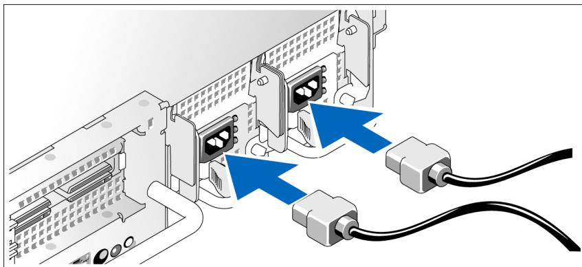
חבר את מתח הציג (אופציונלי) ומתח המערכת, וחבר את כבלי החשמל של המערכת למחרת . אם המערכת כוללת כרטיס הרחבה עם מחבר ליציאת וידאו , אל תחבר את הציג למחבר הווידאו המשולב של המערכת . במקומות זאת, לחבר את כבל הציג למחבר בכרטיס הרחבה .
