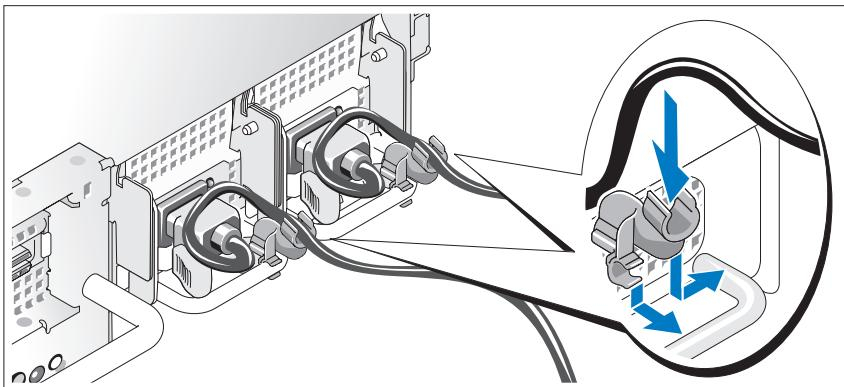
Fixez le support du cordon sur la partie droite de la poignée du bloc d'alimentation. Faites une boucle comme indiqué dans l'illustration et insérez le cordon d'alimentation dans le clip du support. Recommencez cette procédure pour le second bloc d'alimentation.
