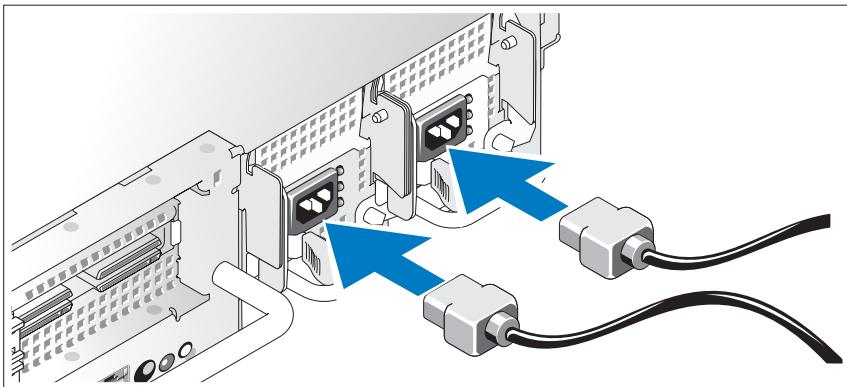
Insérez les cordons d'alimentation du moniteur (facultatif) et du système dans les connecteurs correspondants. Si le système est équipé d'une carte d'extension dotée d'un connecteur de sortie vidéo, *ne connectez pas* le moniteur sur le connecteur vidéo intégré du système mais sur celui de la carte d'extension. Branchez ensuite l'autre extrémité du cordon sur une prise de courant mise à la terre ou sur une source d'alimentation autonome (onduleur ou unité de distribution de l'alimentation).
