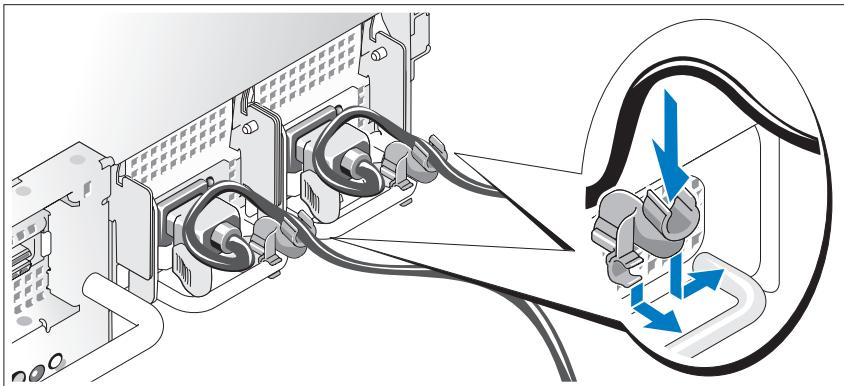
Podłącz wspornik podtrzymujący kabel zasilania do prawego węzła na uchwycie zasilacza. Utwórz na kablu zasilacza pętlę w taki sposób, jak pokazano na ilustracji, i przymocuj ją do zacisku kabla na wsporniku. Powtórz te czynności dla drugiego zasilacza.
