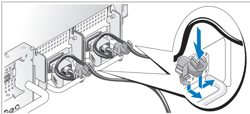
Bringen Sie die Rückhalteklemme für das Netzstromkabel am rechten Bogen des Netzteilgriffs an. Biegen Sie das Netzstromkabel wie abgebildet zu einer Schlaufe und befestigen Sie es an der Kabelklemme. Wiederholen Sie den Vorgang für das zweite Netzteil.
