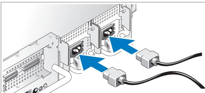
Podłącz monitor (opcjonalny) i zasilanie systemu oraz kabel (kable) zasilania do systemu. Jeżeli system posiada kartę rozszerzeń ze złączem wyjścia grafiki, *nie* podłączaj monitora do zintegrowanego złącza grafiki systemu. Zamiast tego podłącz kabel monitora do złącza karty rozszerzeń.
