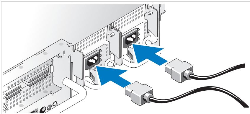
Conecte la alimentación del monitor (opcional) y del sistema, y conecte los cables de alimentación al sistema. Si el sistema tiene una tarjeta de expansión con un conector de salida de vídeo, *no* conecte el monitor al conector de vídeo integrado del sistema. En su lugar, conecte el cable del monitor al conector de la tarjeta de expansión.
