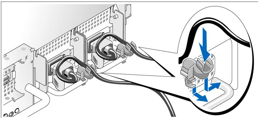
חבר את כנ הרכבה להגנה על כבל החשמל בכיפוף הימני של ידית ספק הכוח . קופף את כבל החשמל של המערכת וצור ממנו לולאה כמו צג באיר. לאחר מכן לחבר אותו לתפס הכבב בcn הרכבה . חזרה על הליך זה עבור ספק הכוח השני .
