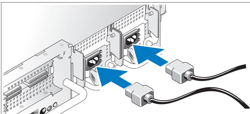
Připojte monitor (volitelný) a napájení systému a napájecí kabel(y) připojte k systému. Je-li systém vybaven rozšiřovací kartou s výstupním videokonektorem, **nepřipojte** monitor do videokonektoru integrovaného v systému. Namísto toho připojte kabel monitoru do konektoru rozšiřovací karty.
