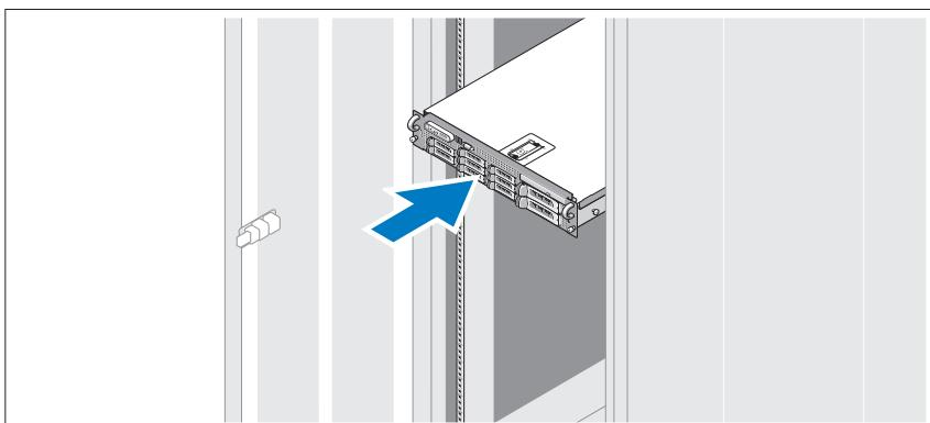
Ознакомьтесь с “Инструкциями по технике безопасности”, представленными в документации по установке системы в стойку, а затем установите направляющие и систему в стойку.
